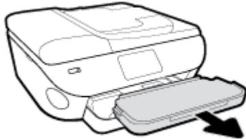
2. Bringen Sie die Ausgabefachsperrung an der Unterseite des Ausgabefachs in die geöffnete Position. Verschieben Sie dann den Freigabehebel, um die Ausgabefachverlängerung frei zu geben.
