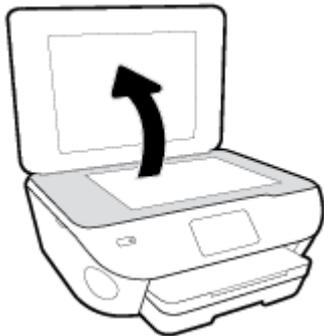
2. Reinigen Sie das Scannerglas und die Unterseite der Abdeckung mit einem sauberen, fusselfreien Tuch, das mit einem milden Glasreinigungsmittel angefeuchtet wurde.
