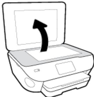
2. Legen Sie das Original mit der bedruckten Seite nach unten so auf das Scannerglas, dass es vorne rechts anliegt.
